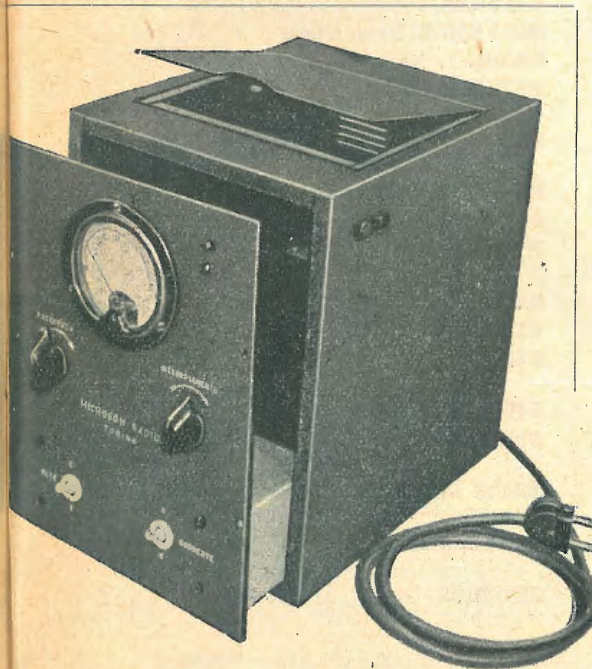
Fig. 3. - Una cassetta metallica (vedi dimensioni a fig. 2) racchiude il trasmettitore. Il comando a destra varia l'accoppiamento della spira d'antenna; quello a sinistra varia la frequenza di emissione facendo scorrere il ponticello di cortocircuito. Dei due interruttori sottostanti, quello di destra (non indicato sullo schema perchè facoltativo) interrompe il collegamento a massa del Centro A.T. del trasformatore TA; l'altro è l'interruttore I.
